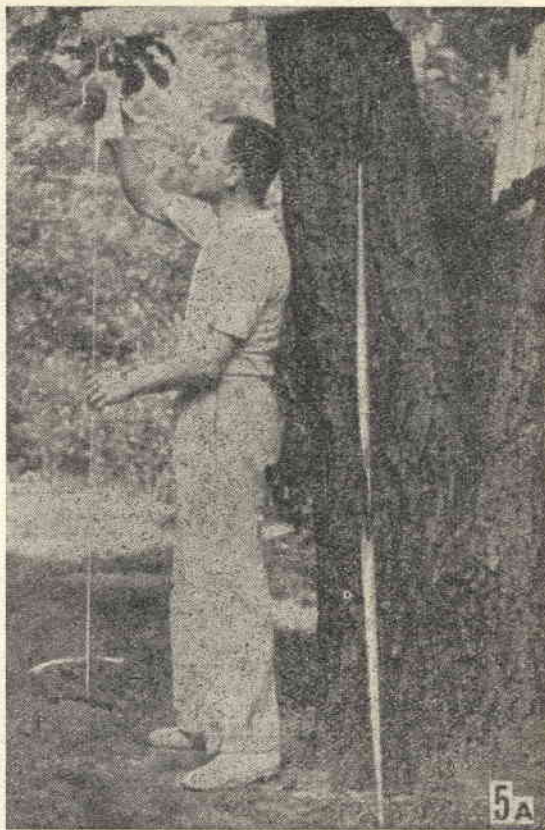
Foto n. 5a - Applicazione della cera di api sulla corda già ritorta. All'estremità superiore essa viene legata ad un ramo di albero mentre l'estremità inferiore viene appesantita con una grossa pietra. La pietra serve anche per eseguire in maniera uniforme la ritorcitura. Poi, sempre lasciando la corda in questa disposizione, su di essa viene passato, con fozza, un pezzo di carta da imballaggio, pesante. Il calore che si forma per l'attrito, determina la funzione della cera e questa avvolge i sei capi che compongono la corda e li unisce insieme in maniera stabile.
