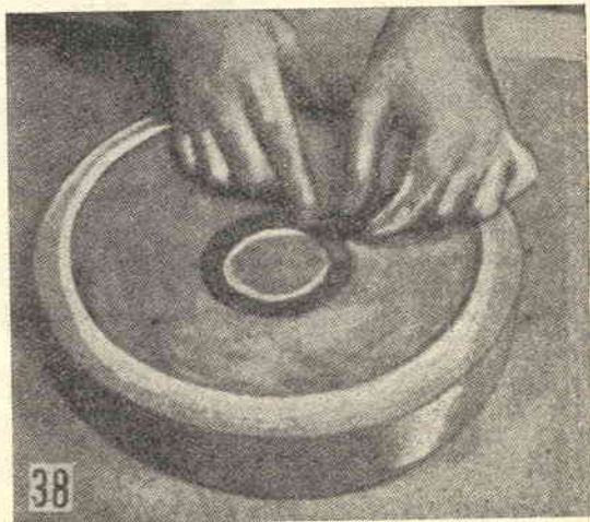
38) Nel fondo della forma, dove vi è la cavità corrispondente al piede del piatto, forzare una striscia di argilla umida, livellandola bene, specie verso l'alto.
