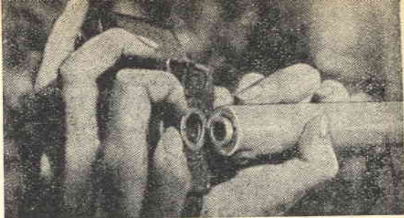
Disposizione particolare nel caso che la macchina da presa sia del tipo Bell & Howell da 8 mm. come la mia: osservare il collare di adattamento e l'incavo, che serve ad impegnare il denton che si trova sul portaobbiettivo della macchina.
